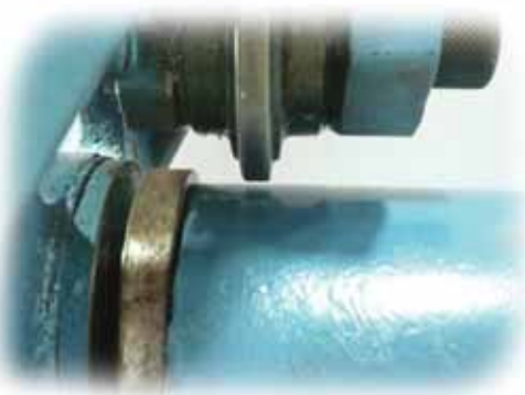
สอดท่อให้หน้าตัดท่อชนแนบกับหัวกรู๊ป
